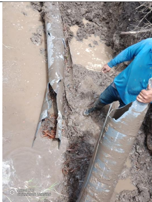
Registro evidente del alto deterioro de la tubería por cristalización del material PVC.
