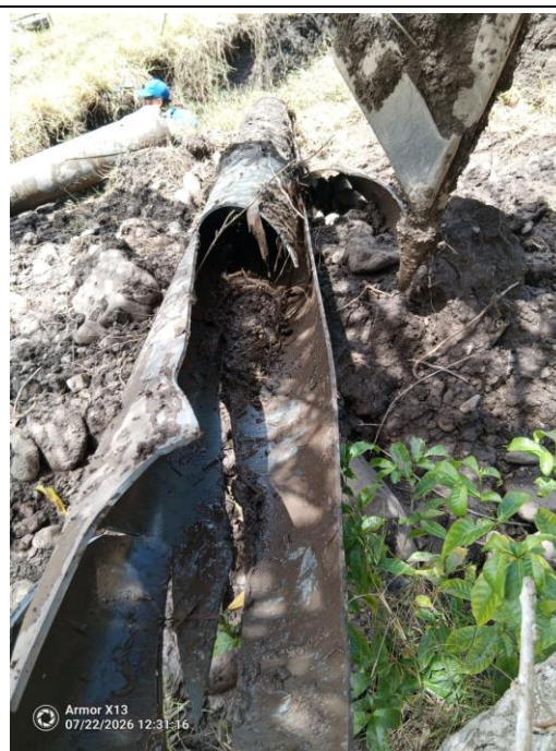
Registro evidente del alto deterioro de la tubería por cristalización del material PVC.
